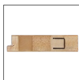
SKRZYDŁO O GRUBOŚCI 46 mm WZMOCNIŁO MASYWNYM CEOWNIKIEM STALOWYM
